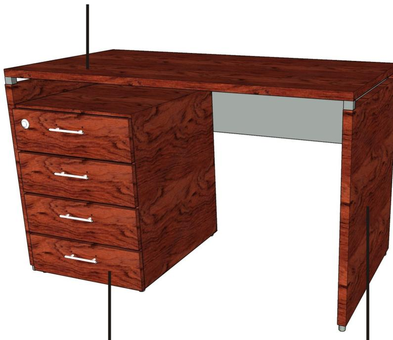
2 Pés em MDF cor noce com espessura de 24mm. 2 Apoios em aço com regulagem de rosca interna.
